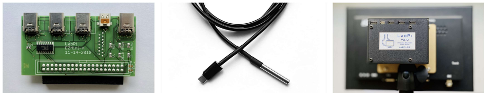
Abb. 2: Adapterplatine (links), Temperatursensor (Mitte) und die zusammengebaute LabPi-Station auf einem Touch-Display (rechts).
