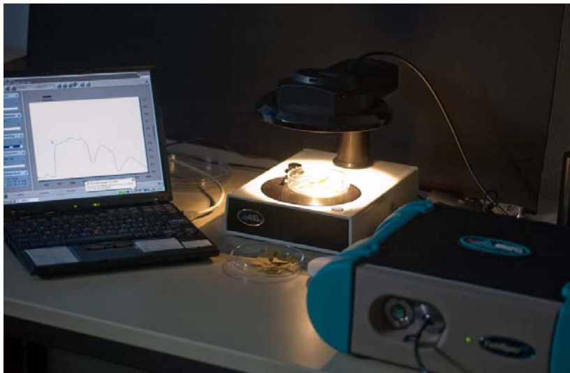
FieldSpec 3 im Laboreinsatz (externe Beleuchtung und in Kombination mit dem Turntable).
